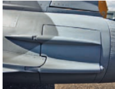
Die Bremsklappen am Heck sind herstellerseitig so vorbereitet, dass sie ausfahrbar gestaltet werden können. Zwecks Gewichtsersparnis wurden sie im vorliegenden Fall aber fest verklebt.
