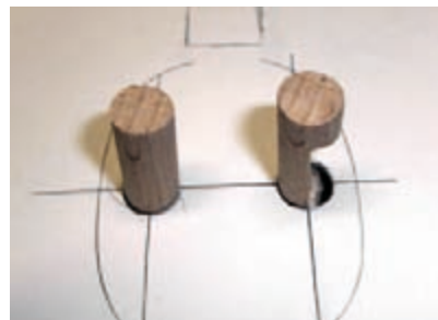
Eingeharzte Buchendübel dienen als Gewindeträger für die abnehmbaren Waffenträger.
