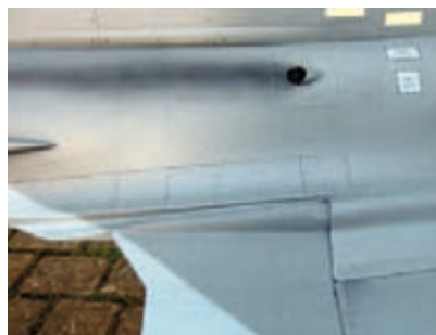
Der Rumpfübergang und der von diesem überdeckte Teil der inneren Elevons müssen an den Stirnflächen geöffnet werden, damit die Flächen an den Rumpf gesteckt werden kann.
