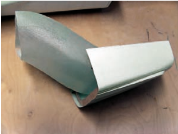
Die Luftführung wird im Einlauf verklebt und kann mit diesem später zu Wartungszwecken abgenommen werden.
