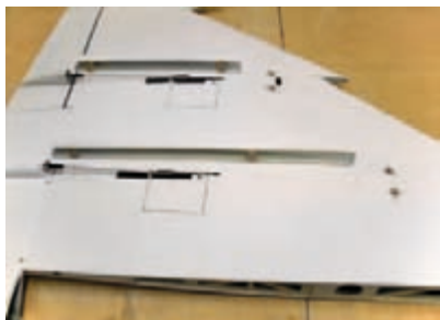
Über die Ruderanlenkungen kommen Scale-Abdeckungen, so ist die Anlenkung am fertigen Modell nicht sichtbar.
