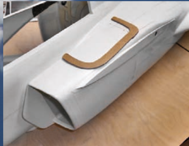
◀ ▲ In die Lufteinläufe werden im aufgesetzten Zustand C-Spanten plan zum Rumpfanchluss eingeharzt.
