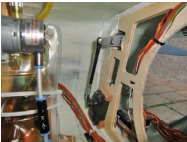
► Zur Montage der Servos werden in den Flächen die Montageplätze freigelegt.
