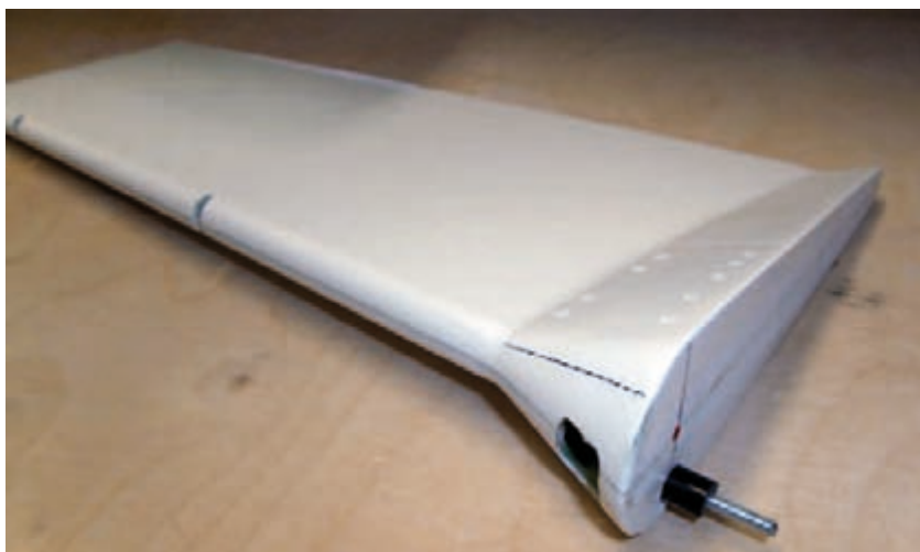
Die Seitenruderanlenkung wird an dessen Wurzel eingeharzt, das Servo über Kopf im Rumpf-Seitenruderübergang.
