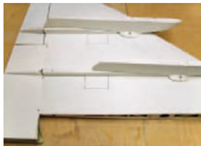
Über die Ruderanlenkungen kommen Scale-Abdeckungen, so ist die Anlenkung am fertigen Modell nicht sichtbar.
