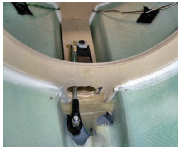
Die Seitenruderanlenkung wird an dessen Wurzel eingeharzt, das Servo über Kopf im Rumpf-Seitenruderübergang.
