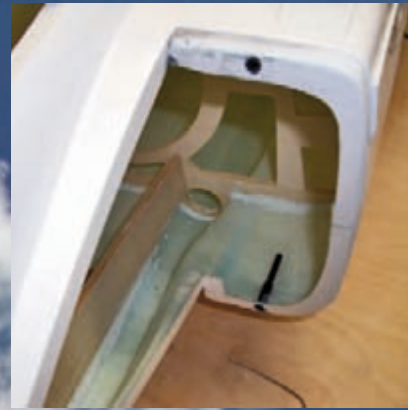
Zwei CFK-Führungsrohre sichern die Passung des abnehmbaren Lufteinlaufs.
