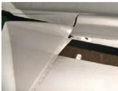
Der Rumpfübergang und der von diesem überdeckte Teil der inneren Elevons müssen an den Stirnflächen geöffnet werden, damit die Flächen an den Rumpf gesteckt werden kann.
