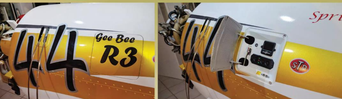
Hinter dem Deckel befindet sich die Schaltzentrale, die Optik wird dadurch nicht gestört.
