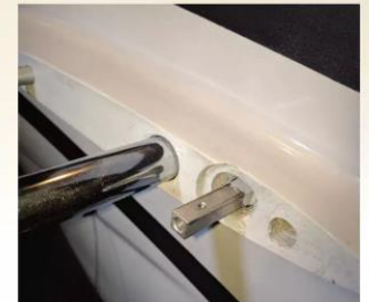
Die beiden Höhenruder-Servos sitzen im Seitenleitwerksholm und bedienen die Höhenruder redundant. Die Vierkantsteckung zur Anlenkung der Höhenruderblätter ist mittig getrennt.
