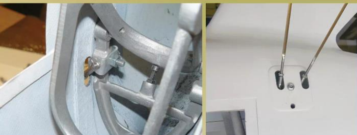
Die Spannseile wurden direkt am Fahrwerksbügel befestigt.
