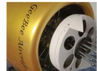
Der Spinnerübergang: Die Kühlluft wird direkt zu den Zylindern geführt.
